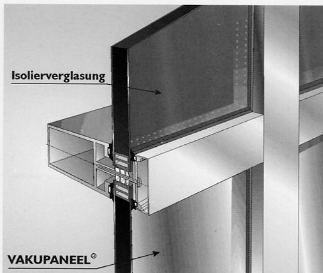
fig. 2-39 Façades poteaux-traverses isolées
