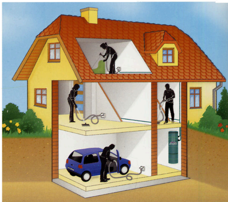
fig. 6-1 Aspiration centralisée avec l'installation centrale à la cave
