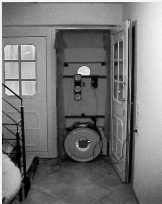
fig. 4-14 Test Blower-Door en état d'installation
