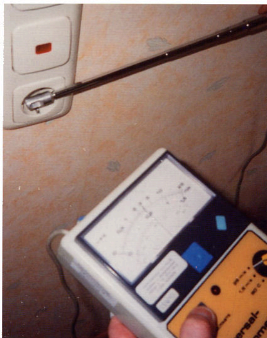
fig. 4-15 Mesure des fuites sur la prise électrique
